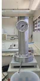
Figura 2 – Módulo experimental de filtração com membranas
