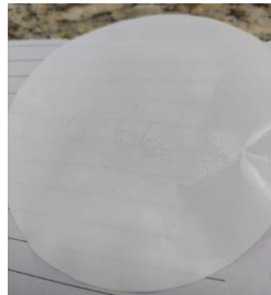
Figura 3 – Membrana comercial funcionalizada com a MOF UIO-66
