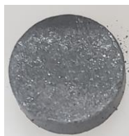
Figura 4 – Pastilha de ZrO 2 /2% vol. Al 2 O 3 -NbC após sinterização com proteção de grafite.
