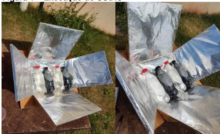
Figura 1 – Execução do SODIS
