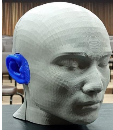
Figura 2 – Cabeça artificial binaural 3D e equipamentos utilizados durante as medições
