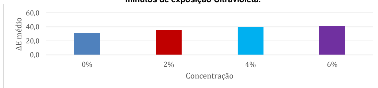
Gráfico 1 - \Delta E médio em relação a diferentes concentrações de 0%,2%,4% e 6% \text{TiO}_2 , após 60 minutos de exposição Ultravioleta.
