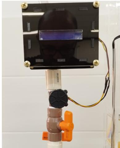
Figura 3 – Fotografia do sistema de medida de vazão conectado em série com o registro esfera, responsável por regular a a vazão. Fonte: Autoria própria (2023).
