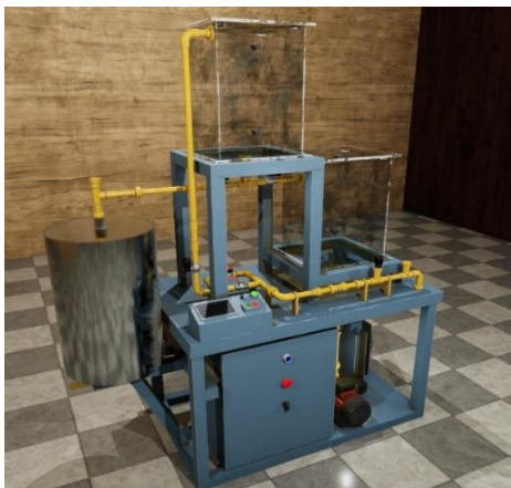
Figura 1 - Simulador 3D do gêmeo digital da Bancada.
