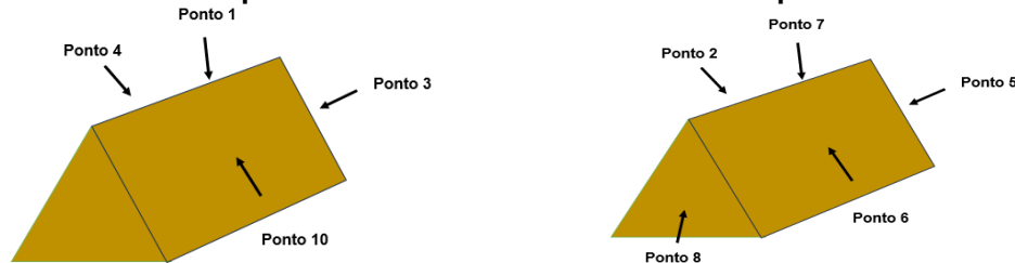
Figura 1 – Posicionamento dos sensores nas leiras sem e com biopolímeros
