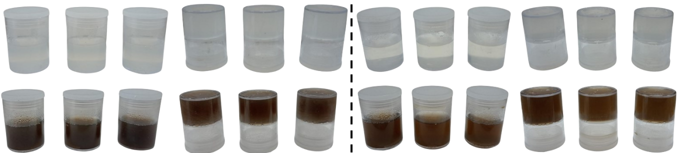
Figura 1 - Amostras de Hidrogéis 50-50 GE/GG (Esquerda) e Hidrogéis 75-25 GE/GG (Direita) sem e com GO. Condições preparadas em triplicata.
