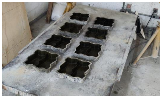
Figura 4 – Mesa vibratória com as formas lubrificadas
