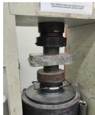
Figura 6 – Ensaio de resistência à compressão
