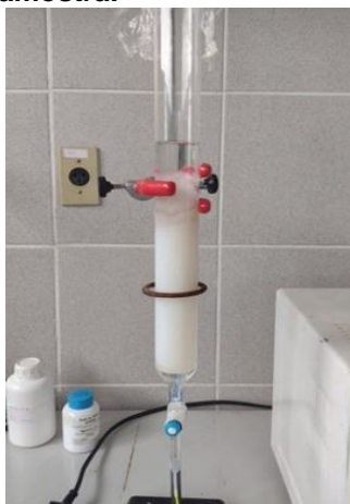
Figura 1 – cromatografia de troca iônica para purificação e fracionamento da amostra.
