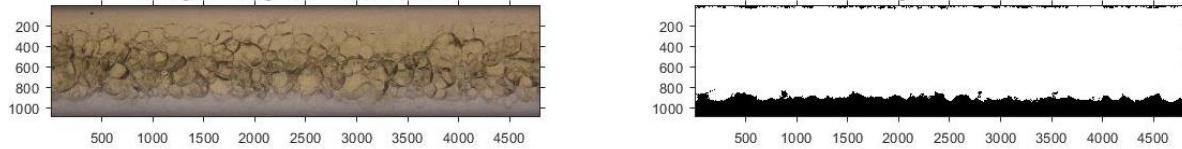
Figura 4 – Imagem para as velocidades J_w=0,1\text{m/s} e J_k=0,4\text{m/s} e sua respectiva binarização.
