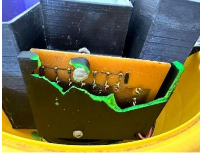
Figura 4 – Estrutura instalada em campo experimental danificada.
