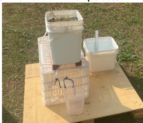
Figura 3 – Lisímetro e mini-tanque classe A instalados.
