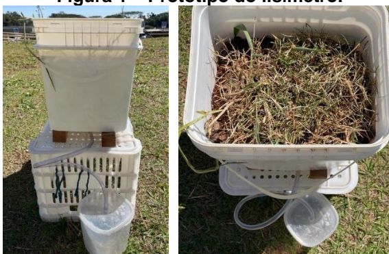
Figura 1 – Protótipo do lisímetro.
