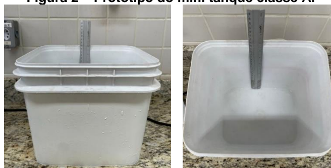
Figura 2 – Protótipo do mini tanque classe A.
