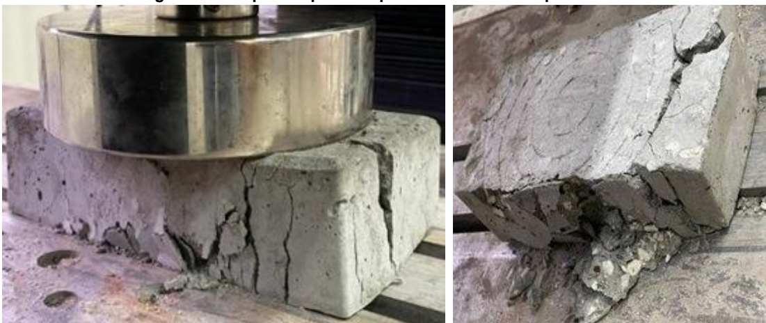
Figura 3 – Corpos de provas após o ensaio de compressão.
