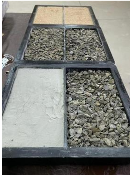
Figura 1 – Traço volumétrico de concreto convencional
