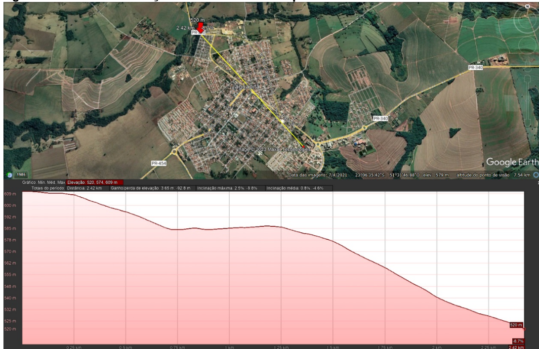
Figura 3 – Perfil de Elevação do Reservatório Apoiado até um Nó com Cota Baixa
