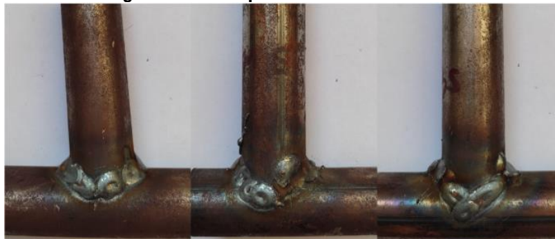
Figura 4 – Solda pelo método tradicional.
