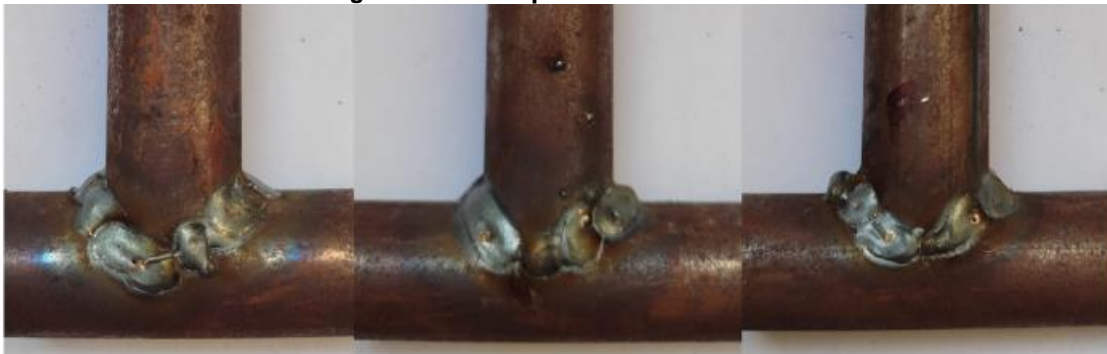
Figura 5 – Solda pelo método automático.
