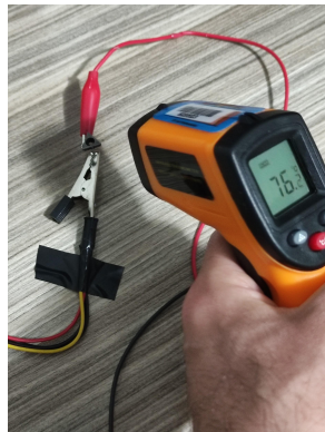
Figura 2 - Validação do termômetro infravermelho
