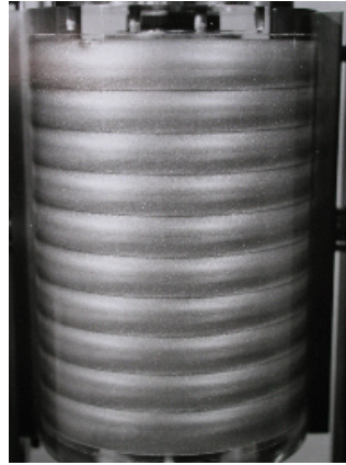
Figura 2 – Instabilidades de Taylor-Couette em um experimento a Ta_c .
