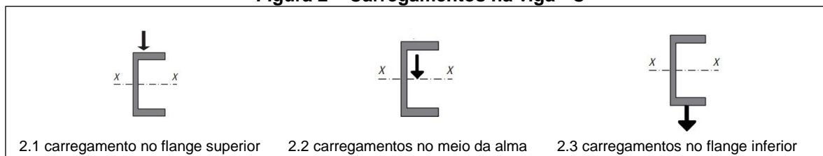
Figura 2 – Carregamentos na viga - U
