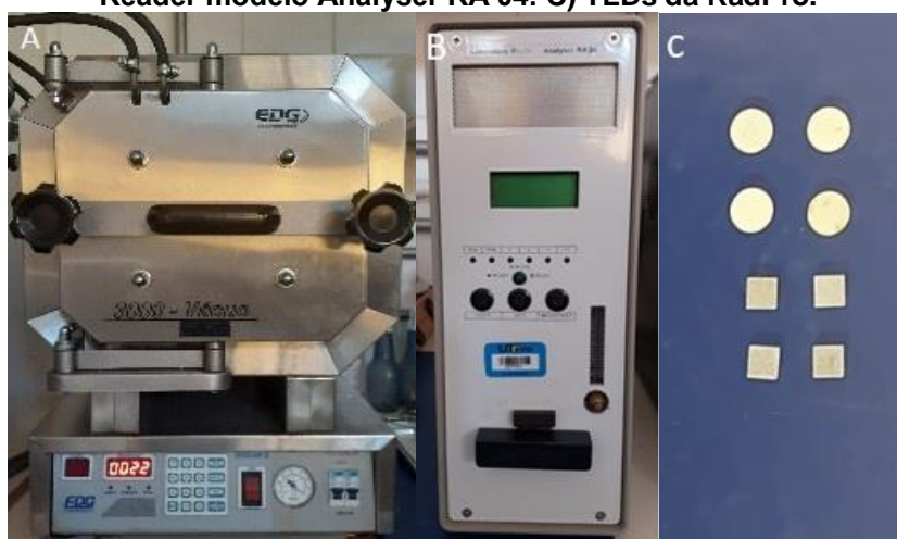
Figura 1 – A) Forno para tratamento térmico EDG Equipment Model 10P, 3000. B) Leitora Laboratory Reader modelo Analyser RA'04. C) TLDs da RadPro.
