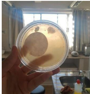
Figura 5 – Placa de petri contendo solo, com filtro embebido em gasolina.
