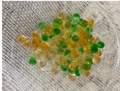
Figura 2 – Imagem de leveduras imobilizadas em alginato de sódio sendo peneiradas.
