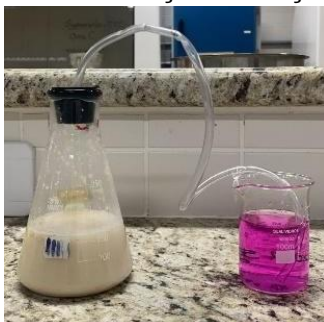
Figura 1 - Erlenmeyer antes da fermentação e solução de NaOH com fenolftaleína.
