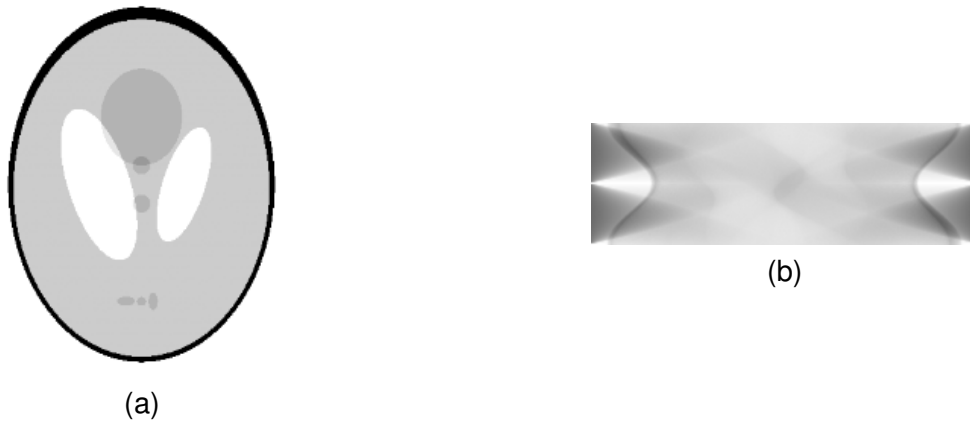
Figura 1 – (a) Espectro de Shepp-Logan (Phantom). (b) Sinograma com 80 projeções do Espectro de Shepp-Logan
