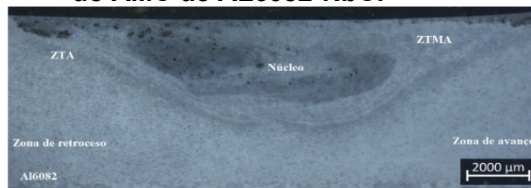
Figura 1. Zonas estruturais da região modificada por fricção e agitação com dois passes e formação do AMC de AL6082-NbC.
