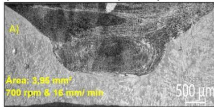
Figura 2 – Imagem macroscópica das amostras modificadas por fricção e agitação e suas respectivas áreas, nas condições a) 700 rpm e 16 mm/min b) 850 rpm e 22 mm/ c) 1100 rpm e 28 mm/min
