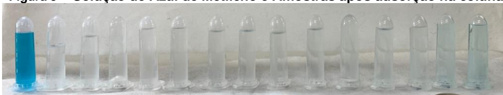
Figura 3 - Solução de Azul de Metileno e Amostras após adsorção na coluna
