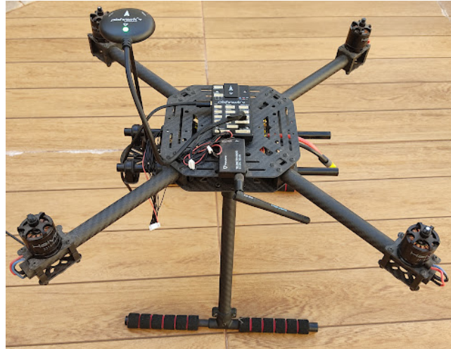
Figura 1 – Pixhawk 4 e receptor GPS Neo-M8N fixados em um quadrotor para os experimentos.
