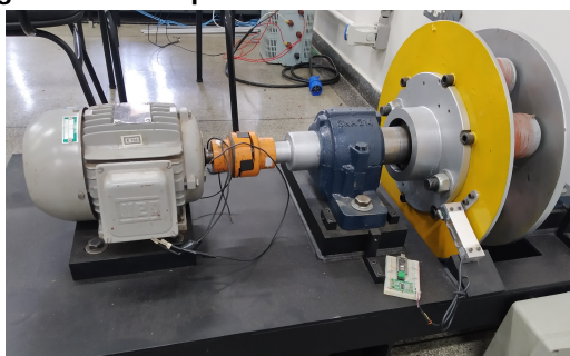
Figura 2 – Protótipo do Freio de Foucault montado
