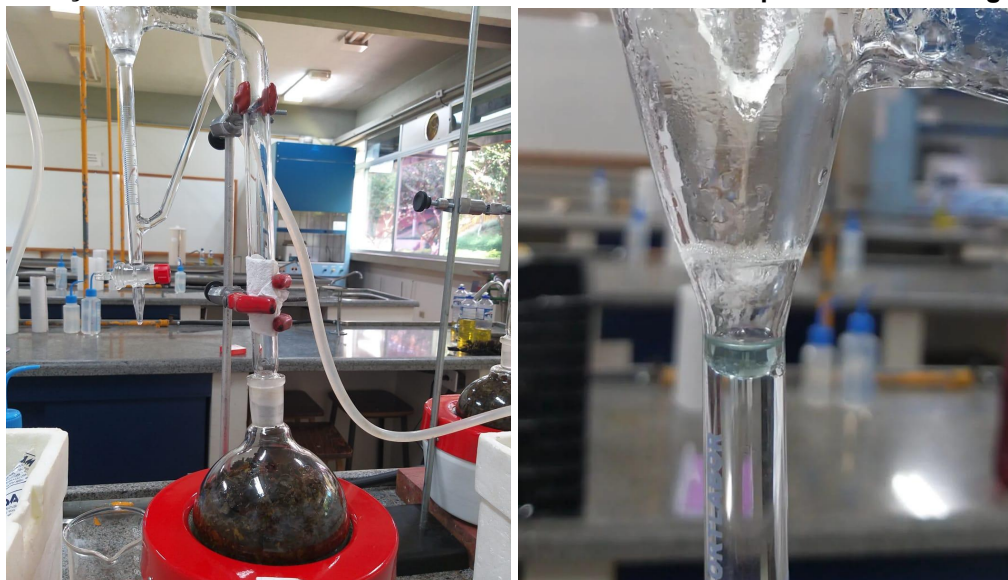
Figura 1- Obtenção de óleo essencial de Erva Baleeira com o uso do aparelho de clewenger.
