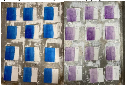
Figura 4- Imagens dos revestimentos com ZnO dopado com AgNO 3 com deposição do corante resazurina (a) antes da exposição à radiação UV, e (b) após a irradiação no tempo 60 min.
