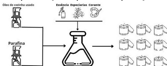
Figura 1 - Representação do processo de produção de vela artesanais
